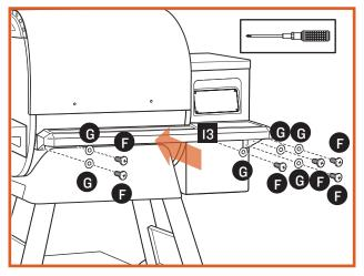
INSTALLATION DE LA POIGNÉE ET DU BAC À GRAISSE AVEC LE REVÊTEMENT
