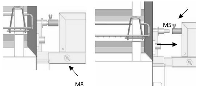
**2<sup>ème</sup> cas ELECTRIQUE** : Faites glisser le moteur (9) sur son support (10) et engagez l'embout moteur (12) sur l'axe broche (13), vissez la vis papillon M5 sur le plat de la broche et bloquez le moteur (9) sur son support (10) à l'aide de la vis papillon M8.
